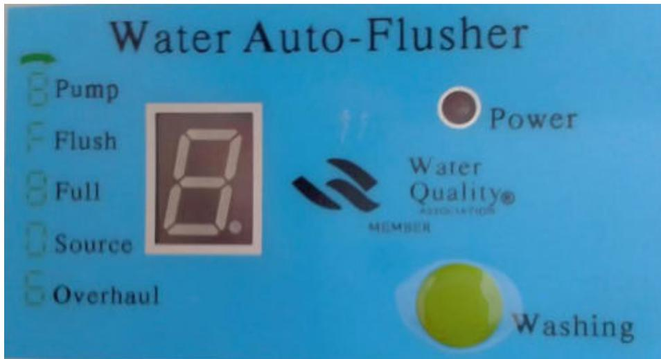
Nach dem Anschließen des Gerätes an das Stromnetz leuchtet die Anzeige **POWER** auf und es wird eine automatische Spülung durchgeführt. Hierbei leuchtet die Anzeige **FLUSH** auf. Für eine manuelle Spülung drücken Sie bitte **WASHING**.
