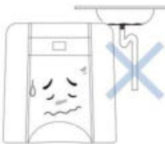
Nehmen Sie das Gerät nicht in Betrieb, wenn der Wasserablauf blockiert ist! Dadurch könnte das Abwasser zurücklaufen und das Wasser verschmutzen.
