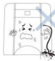
Die Abwasserleitung und der Verhältnisregler dürfen nicht blockiert sein, dies kann zu hohem Verlust von Reinstwasser führen, die Membrane blockieren oder zu Funktionsstörungen des Gerätes führen.
