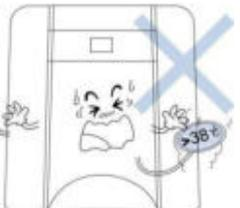
Das Eingangswasser sollte eine Temperatur von 38 °C nicht überschreiten, dies könnte die Umkehrosmose-Membrane beschädigen und zu Funktionsfehlern führen.
