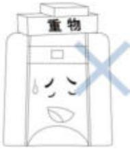
Legen Sie keine schweren Gegenstände auf das Gerät, dies kann die Komponenten im Inneren beschädigen und zu Funktionsstörungen führen.
